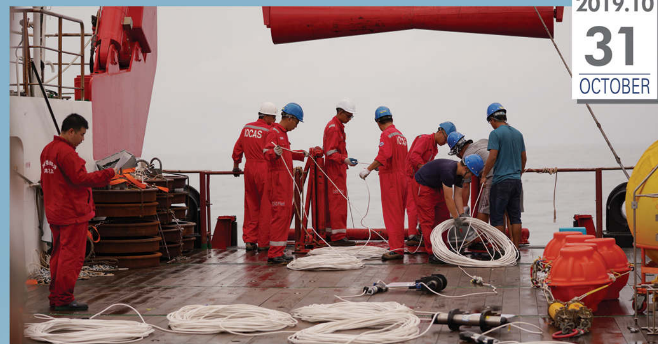
后甲板正在进行潜标布放，缆绳下放有条不紊
