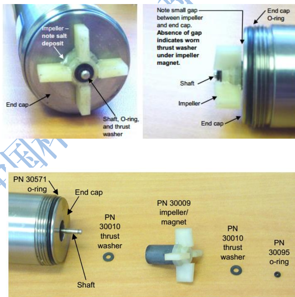
图 4 5T 泵拆卸图
