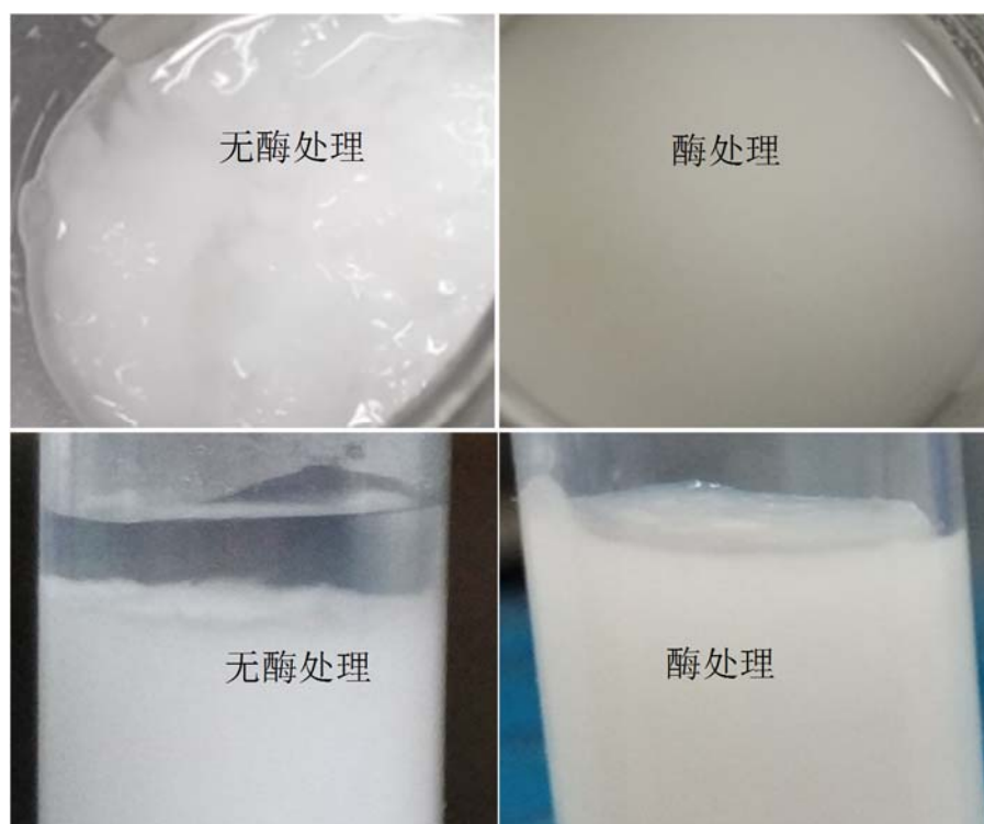
图 1. 酶法处理后冻融稳定性提升，冻融后 1:1 兑水使用性质稳定、不分层
