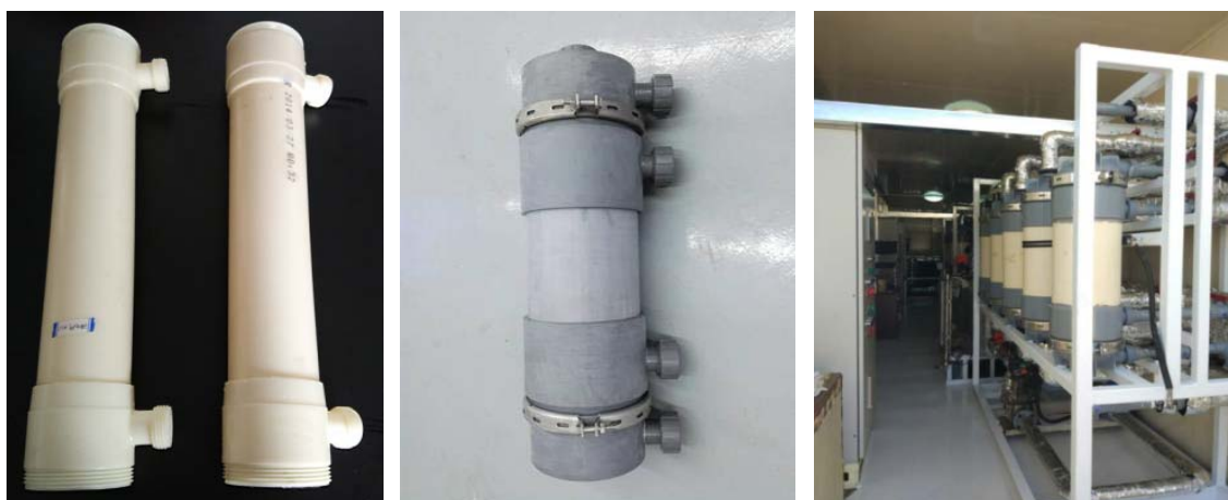
聚四氟乙烯中空纤维膜整理组件及中试系统
